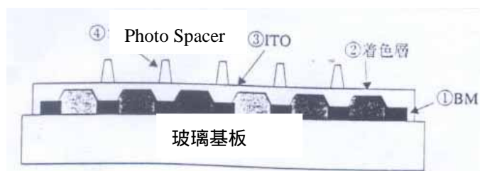
圖 1 彩色濾光片 (Color Filter) 的基本構造
